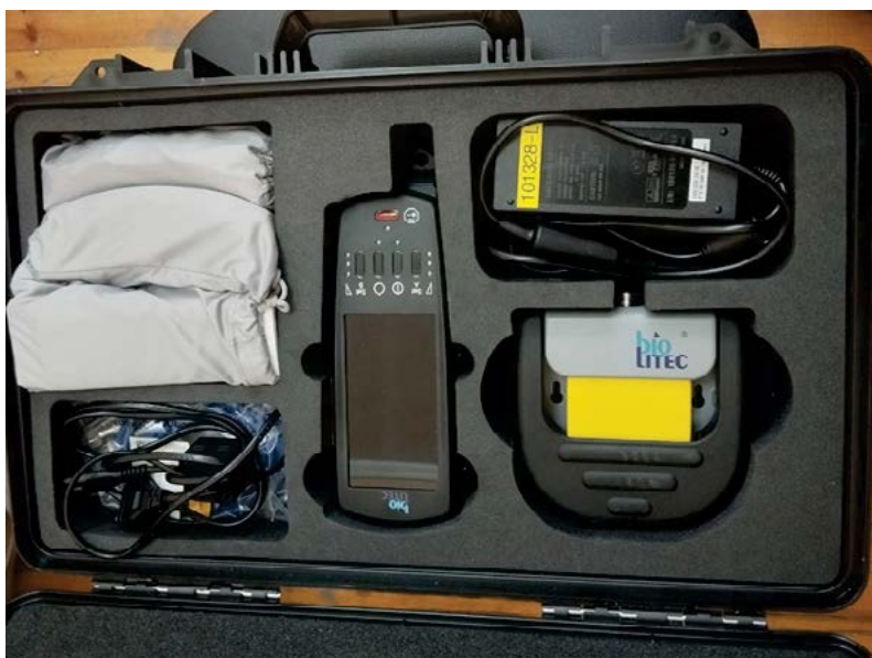
Fig. 1. Diode laser Biolitec LEONARDO MINI 1470 12 watt, Germany.
